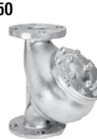
El diseño del arrestallamas en línea/ en conjunto con ventoe permite instalarlo en un tubo de ventoe abierto o en líneas de purga de los tanques de almacenamiento o procesamiento. Adecuado para vapores del Grupo D de NEC (Grupo IIA de IEC).
