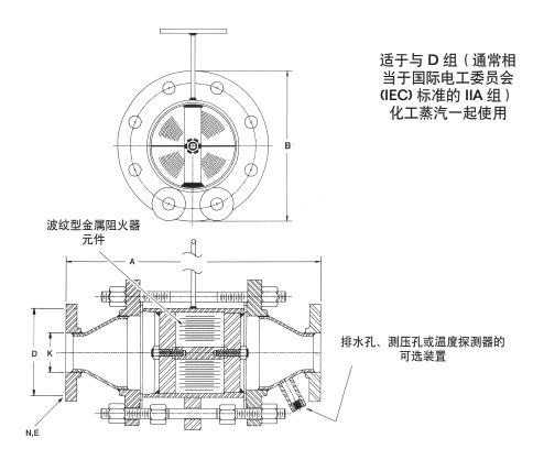
尺寸及订购信息(显示的尺寸仅供参考,请联系厂家获取经鉴定的图纸。)
