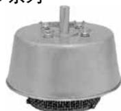
紧急排气阀可保护罐子不会因暴露于火源下而产生过量内压从而导致破裂或爆炸。
